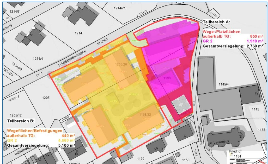
Abb. 21 Ermittlung der Gesamtversiegelung („GRZ 2“) nach Teilbereich A und B; Darstellung Bezugsgröße Umgriff, IST (Planung HKS) und Festsetzung (FS); Stand: November 2023
